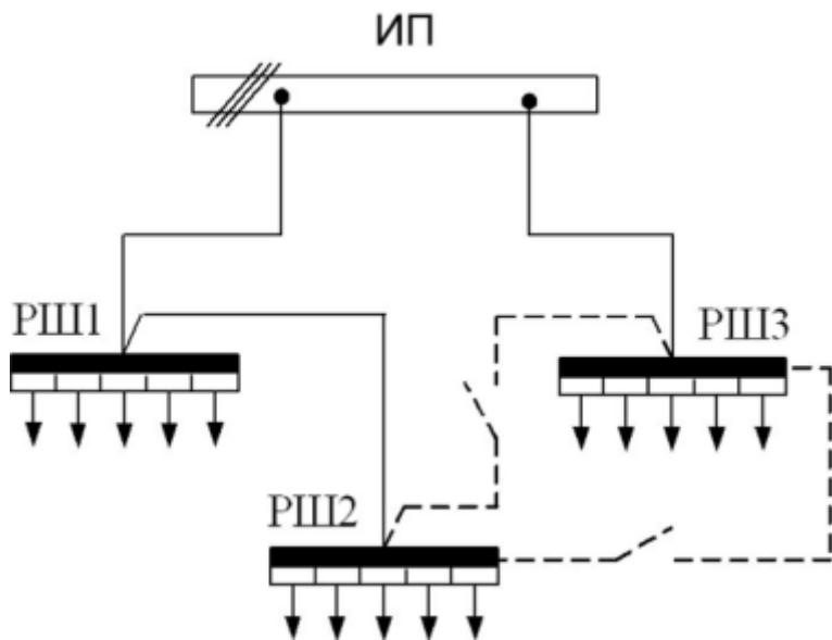
Рис. 12. Магистральная схема с распределительными шкафами
