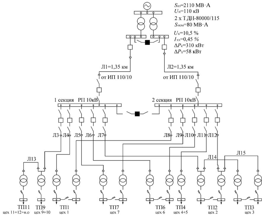
Рис. 1. Упрощенная схема электроснабжения завода
