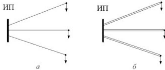
Рис.7. Нерезервированные схемы радиальной системы
