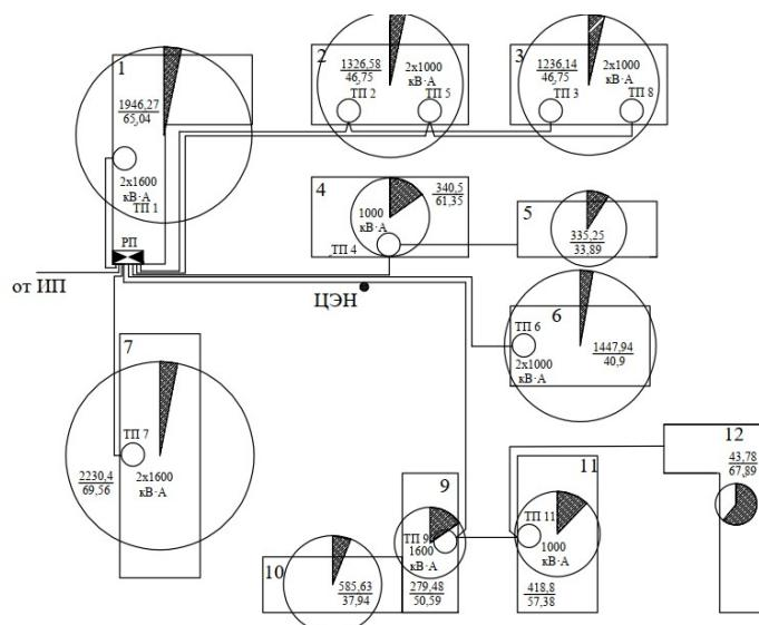
Рис. 14. План схем с распределительной сетью (вариант 2)
