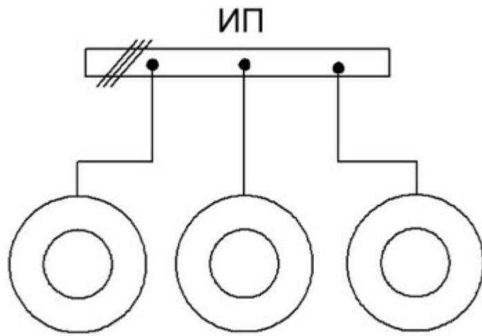
Рис. 10. Типовая схема питания от РУ
