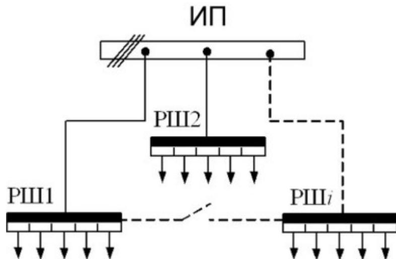
Рис. 11. Типовая схема питания от РШ
